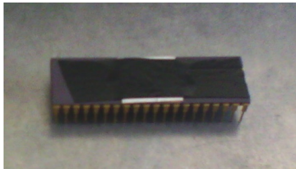
Rysunek 3.1: Chip carrier z badanym układem scalonym.
